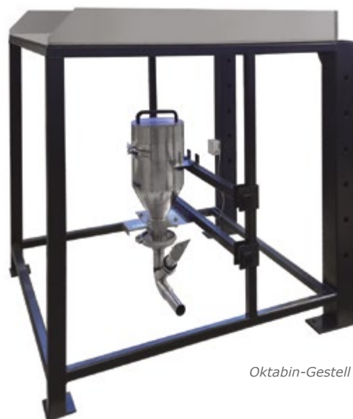
Octabin-Gestell mit kompakter Reinraum-Ausführung
