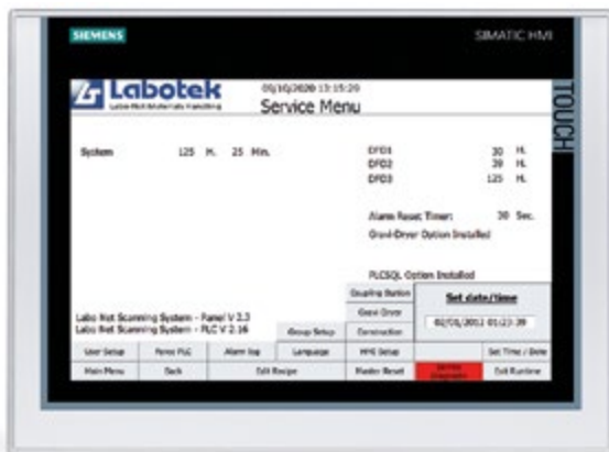
Großes Service Menü mit Zeiteinstellungen und Alarmspeicher
