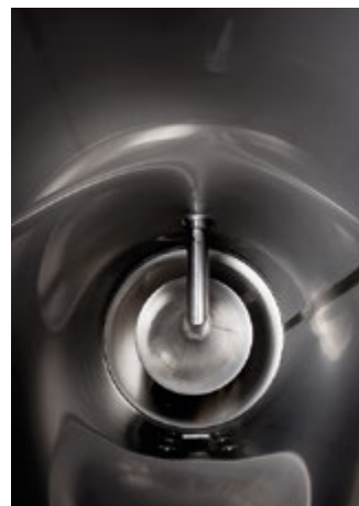
Isolierter Trocknungsbehälter aus Edelstahl mit abnehmbarem Luftverteiler zur einfachen Reinigung.
